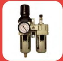
Для подготовки сжатого воздуха в пневмосистемах различного назначения. Две колбы: одна для сбора конденсата, вторая для подачи масла в воздух и смазывания узлов пневматического инструмента. Встроенный манометр позволяет настроить необходимое давления воздуха, подаваемого к пневмоинструменту. Производитель: DMECL
